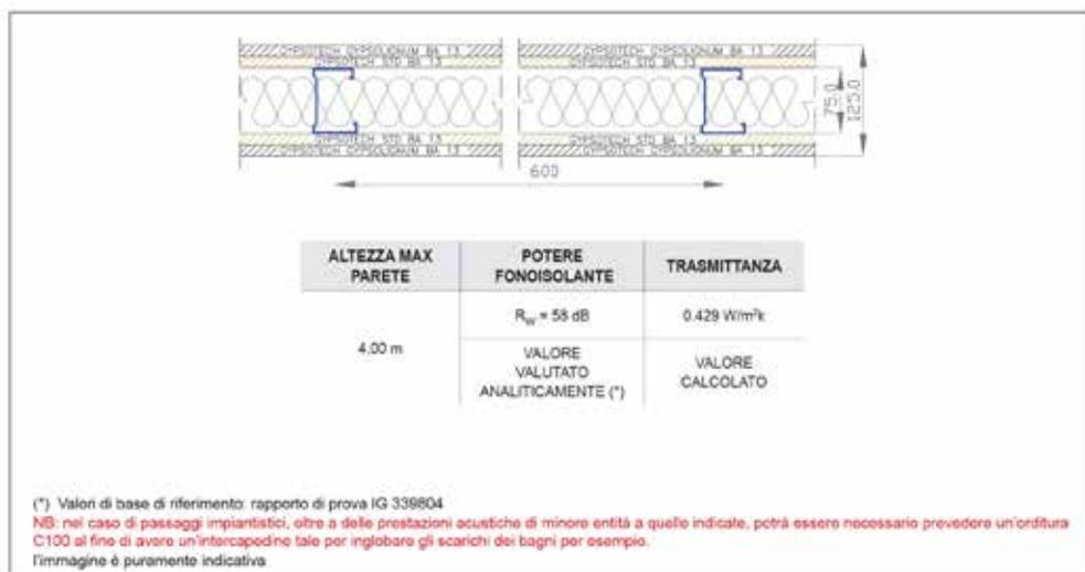
Le pareti interne dei nostri appartamenti sono progettate per offrire comfort e privacy, garantendo un'efficace isolamento acustico e termico. Utilizziamo pareti standard composte da doppie lastre di GypsoTech std su una struttura U75 con lana di vetro per un totale di 125 mm di spessore.
